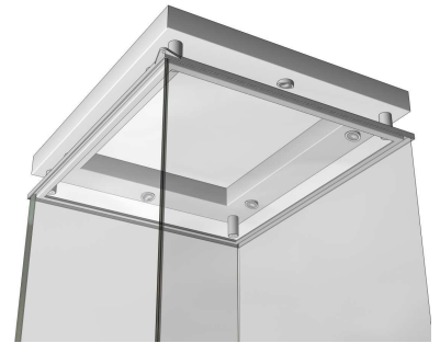
Ilustracja 10: Ramka oświetleniowa--widok od dołu
